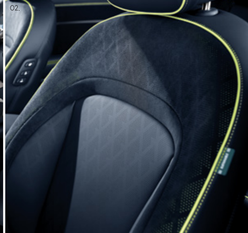
02. 운전석 에르고 모션 시트 _ 시트에 내장된 공기주머니가 최적의 운전자세를 찾아주며, 공기주머니를 개별적으로 제어하는 스트레칭 모드를 통해 주행의 피로를 덜어줍니다. 또한, 주행 모드나 주행 속도와 연동하여 쿠션부와 사이드부의 지지감을 최적화합니다.
